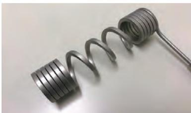
取り付ける軸によりピッチを変えることで軸長のどの点でも同じ温度にできます。
