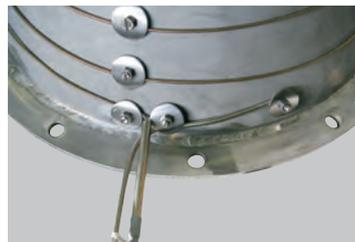
10. ヒーター部を金属固定バンドでとめる場合は、バンドの締めつけねじを電動工具で締めるのはお止め下さい。
